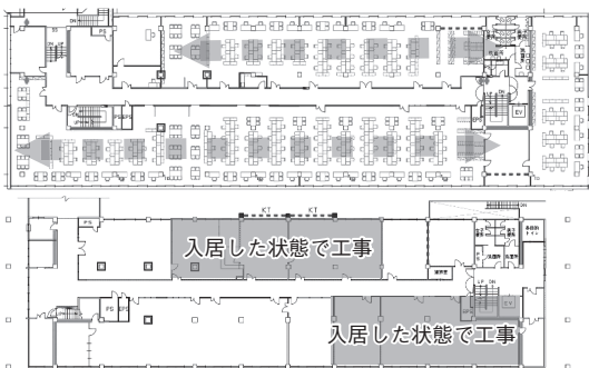
図4 南館の耐震補強箇所(下:1階/上:2階)
