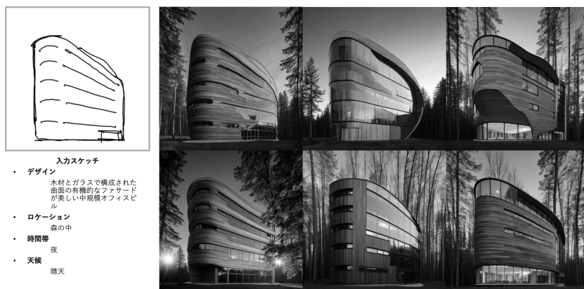
図3 ファサード案生成 AI によるデザイン案生成の一例
