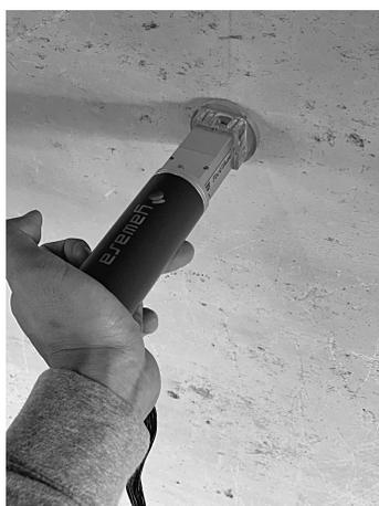
写真2 押込試験による壁土の非破壊検査
