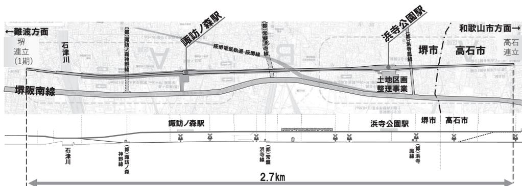
図2 堺連立事業の計画平面図及び縦断面図
