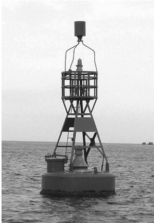
写真1 振動水柱型波力発電装置を利用した航路標識ブイ 2)
